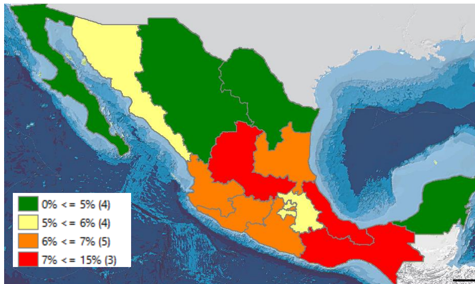
Figura V.7 Mapeo del índice de pérdidas técnicas en Media y Baja tensión por División de Distribución de Distribución.
